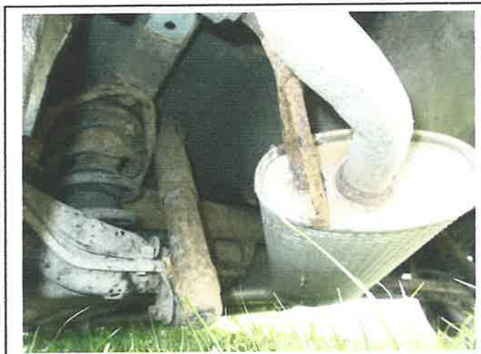
Fot.19. Skorodowane podwozie
