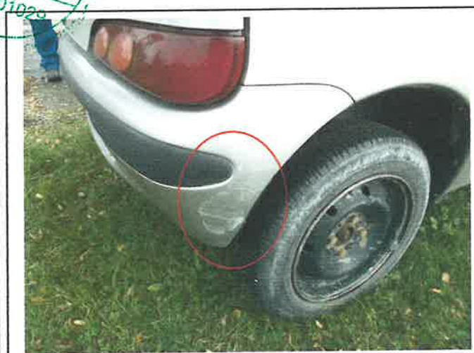
Fot.18. Uszkodzony zderzak tylny
