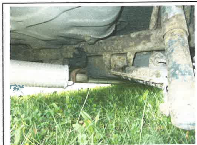
Fot.20. Skorodowane podwozie
