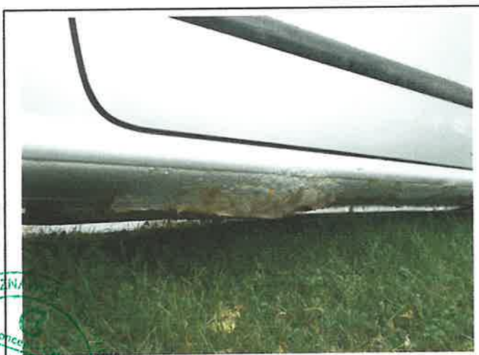
Fot.16. Uszkodzony próg P
